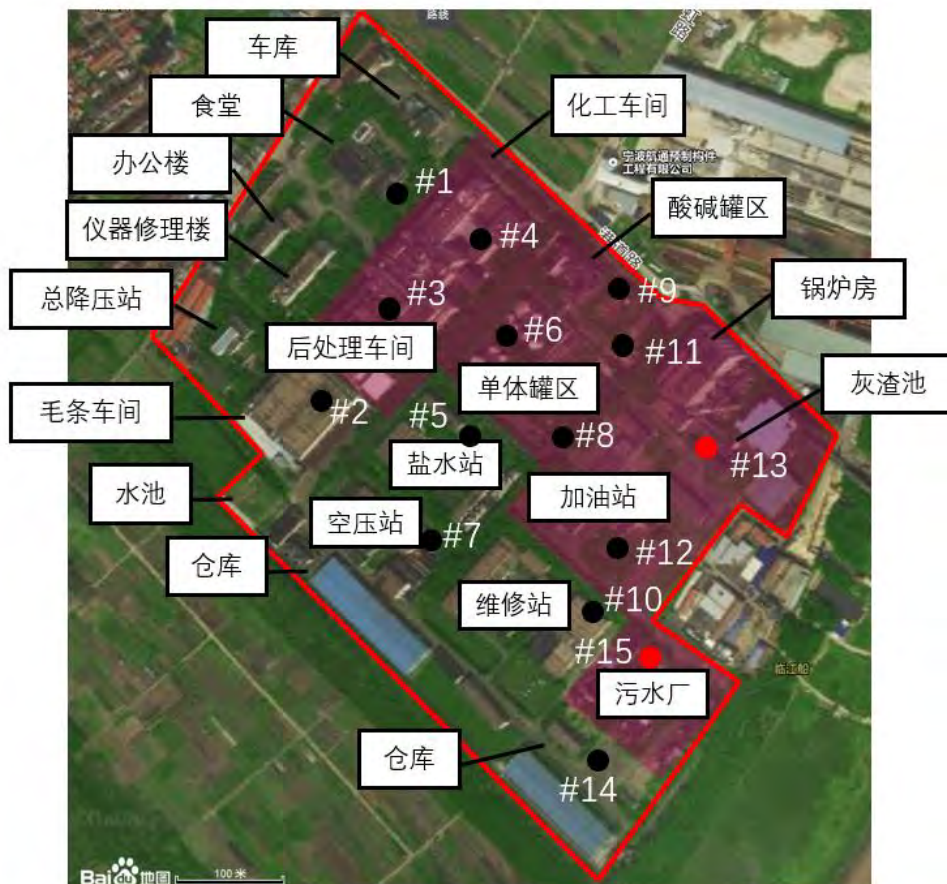
图 3-2 土壤和地下水采样点分布图（黑点为土壤采样点，红点是土壤和地下水采样点）
